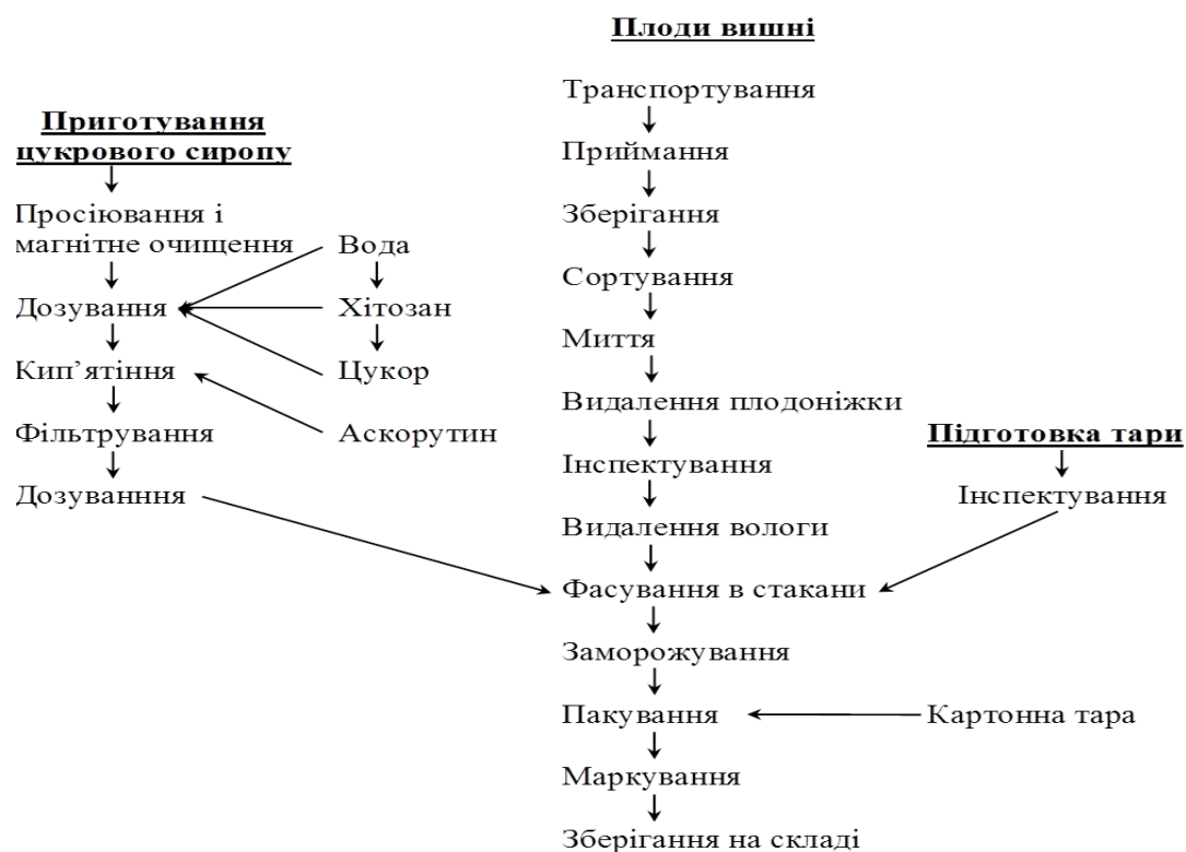
Рис. 25 Технологічна схема виробництва десертної страви “Вишня швидкозаморожена у цукровому розчині”
