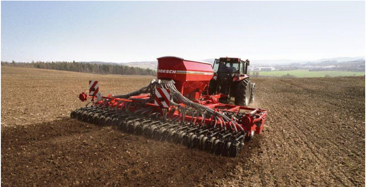
Рис. 2.7 Сівалка зернова Horsch Pronto 6DC.
