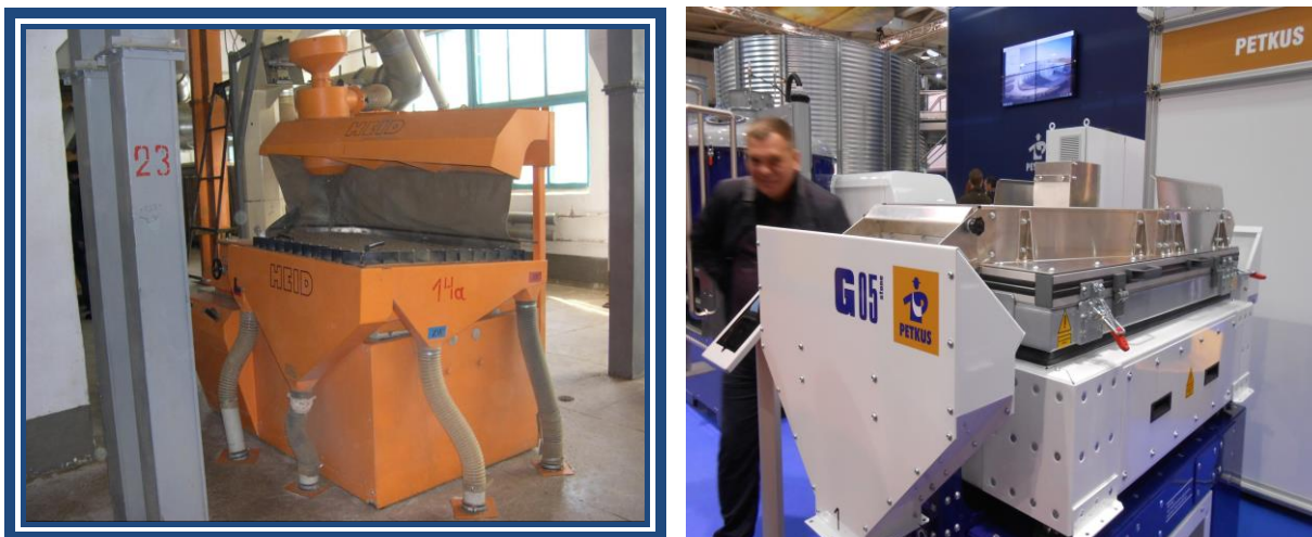
Рис. 7.8. Пневматичні сортувальні столи для сортування насіння за питомою масою у виробничих умовах
