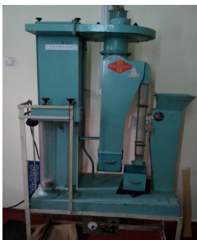
Рис. 7.3. Лабораторна аспіраційна колонка для сортування насіння за аеродинамічними властивостями
